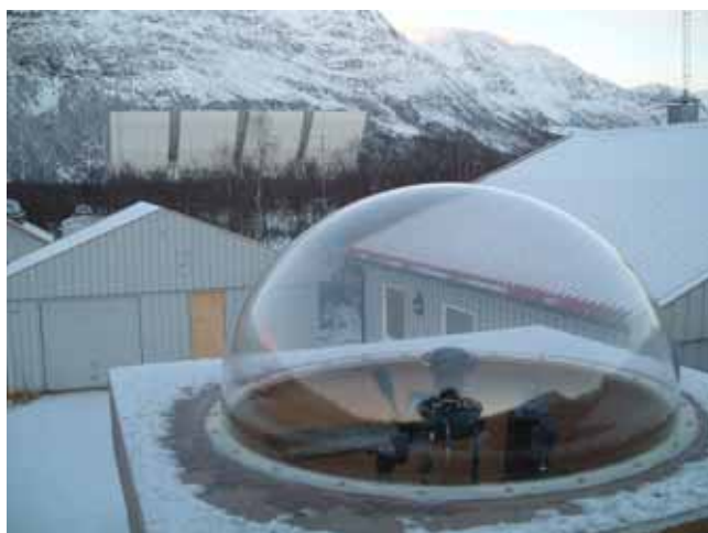
図 4 トロムソに設置された全天カメラ
