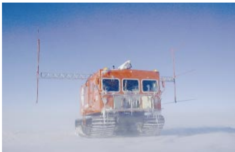
図2：30 MHzレーダを搭載した雪上車の外観。雪上車の左右に送受信アンテナをそれぞれ設置している。アンテナの最大長は5 mを越える。
