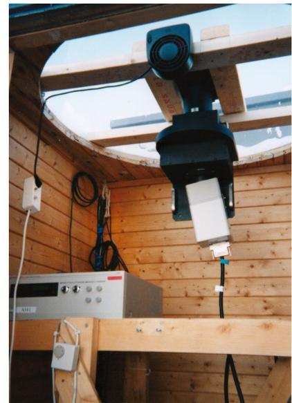
ロングヤーピエンのオーロラ観測所に設置されたオーロラスペクトログラフ。装置はF1.4、f=6mmの魚眼レンズをはじめとする光学系、スリット、波長分散素子としてのグリズム、および高感度 CCD カメラで構成されている。
