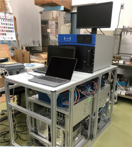
第 67 次隊で新たに設置する新型メタン観測システム（レーザー分光分析計）（後藤大輔 国立極地研究所、以下同）
