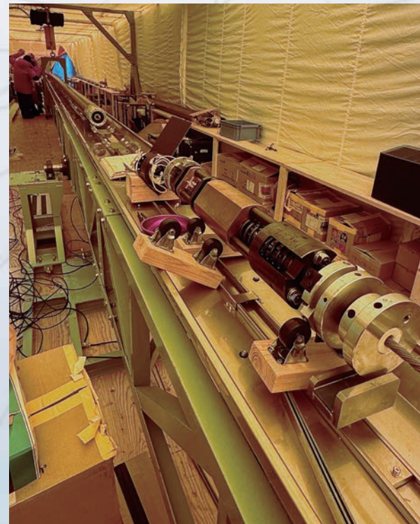
写真2 雪面下に建設された掘削場内部の様子。マストの上に整備中の深層掘削ドリルが載っています。気温は-25℃程度です
