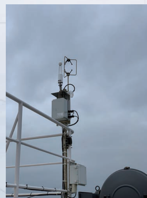
微細な風の動きとともにエアロゾルやガスの濃度を測定するフラックス測定システム
