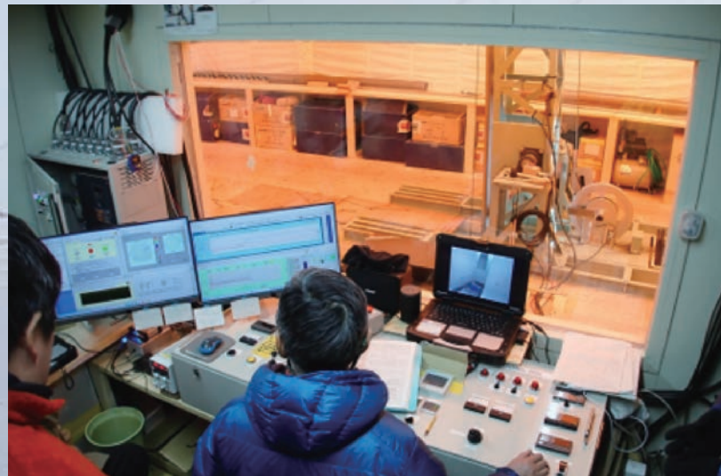
写真3 コントロール室の様子。この部屋は常温で、操作盤や計器類のモニター等があり、ここからドリルを操作してアイスコアを掘削します
