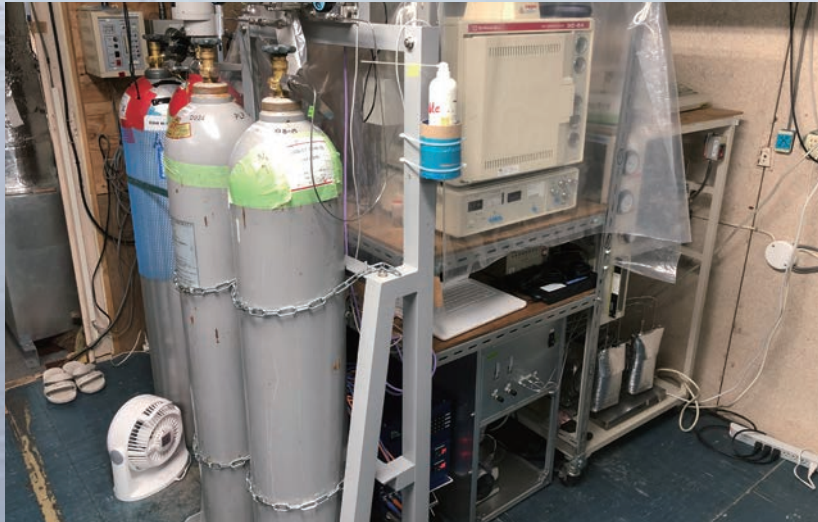
これまで使用してきた昭和基地のメタン観測システム（ガスクロマトグラフ）。保守・点検を行いながら、約40年稼働を続けている
