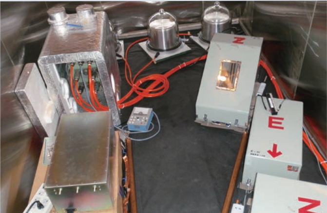
地震計室内の設置の様子（JARE 63：金尾政紀 国立極地研究所以下同）
