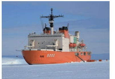
南極観測船「しらせ」 氷厚約1.5mの平坦氷海域を3ノット(時速約5km)で連続砕氷航行が可能な砕氷船です。
