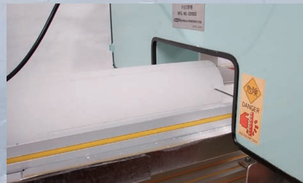
写真4 水平バンドソー。掘削されたアイスコアを切断している様子です
