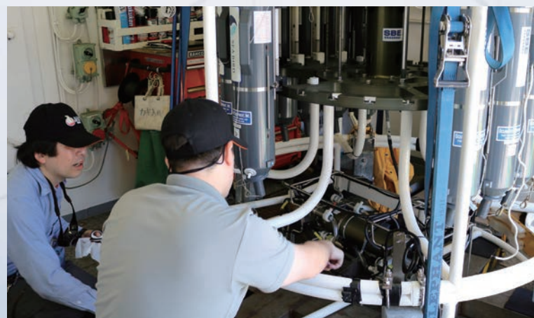
CTD&amp;ニスキン採水器の準備 (JARE66:高橋邦夫 国立極地研究所 以下同)
