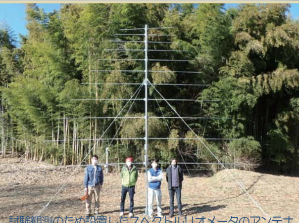
試験観測のため設置したスペクトルリオメータのアンテナ
