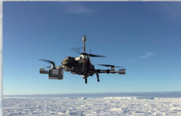
Fig.4 ドローンで気象やエアロゾル数濃度の鉛直分布を計測(JARE64 猪上淳)
