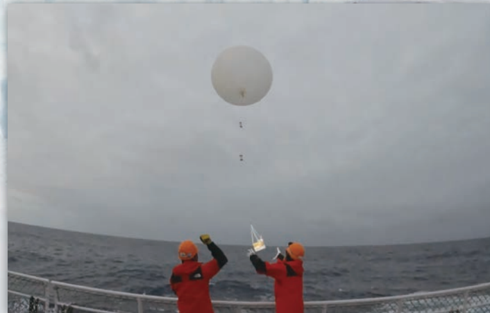
Fig.3 雲粒子センサーゾンデで雲粒の数や大きさ、相状態の鉛直分布を取得(JARE64 白野亜実)
