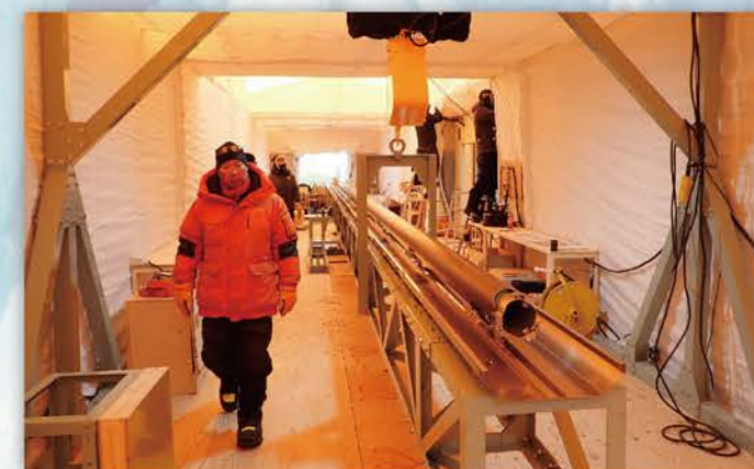
現在の掘削場の様子。深層ドリルの組立までほぼ完了しており、第66次では電子回路などを組み込んで完成させる
