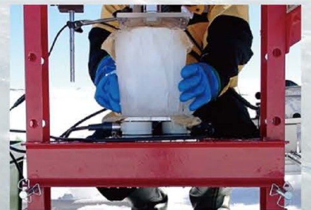
図4. 北の浦における海水コアの一軸圧縮試験。フィールド計測に特化した試験機材を新規に持ち込み、のべ28本のコアから採取した100点以上の試験片から圧縮強度や曲げ強度を得ることに成功した (JARE66 松澤 孝俊)
