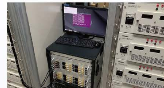
流星ヘッドエコー観測用の付加受信機 (JARE65 田村 厳)
