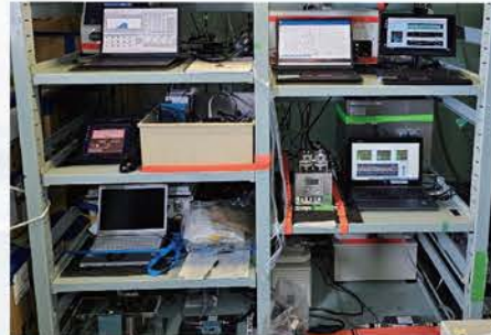
写真3. 「しらせ」第1観測室に設置したエアロゾル観測機器 (JARE66 吉田 淳)
