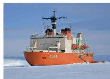
南極観測船「しらせ」 氷厚約1.5mの平坦氷海域を3ノット(時速約5km)で連続砕氷航行が可能な砕氷船です。
