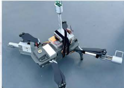
写真2. 小型気象機器やエアロゾルカウンターを搭載した汎用ドローン (JARE66 佐藤 和敏)
