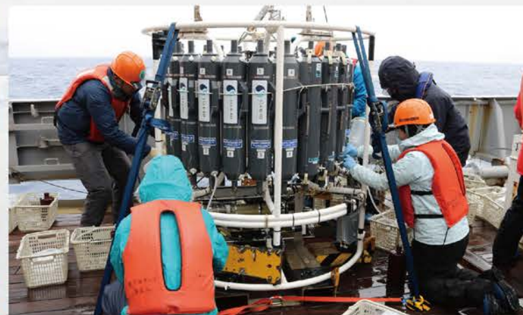
CTDシステムによる南極底層水観測(水温・塩分) JARE66 高橋 邦夫
