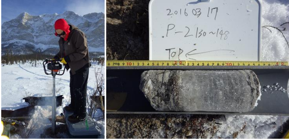
図3. 永久凍土試掘の様子（左）および回収されたコア（右）
