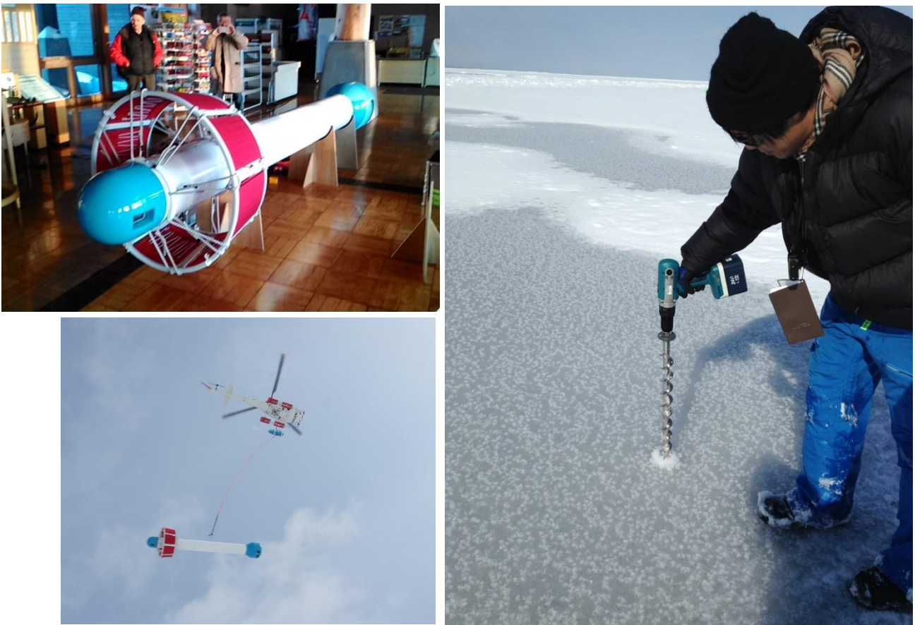
図7.2016年3月1日にサロマ湖氷上で実施した(a)EM-BIRD 組み立て・動作チェック、(b)ヘリ飛行、(c)ドリル掘削の慣熟訓練の様子
