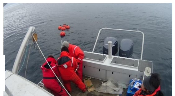
右図) アラスカ沿岸バロー沖における超音波氷厚計を取り付けた係留系回収作業の様子
