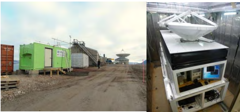
図 1. ノルウェー スパールバル諸島ニーオルスンの国立極地研究所北極観測基地 (78.9° N, 11.9° E) に設置された FALCON-A (右写真) とコンテナ (左写真、緑のコンテナ)。コンテナ天井のテフロン窓を通して、冬期もふくめ常時連続観測を行っている。
