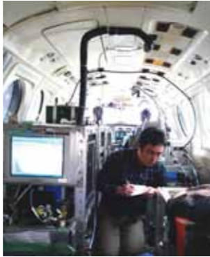
日本では大気観測を行えるチャーター航空機は数が限られています。キャビンの客席を取り外し、各種測定器を搭載した特別機で観測を実施します。機体上部にはエアロゾルや気体の取り込み用インレットがつけられるとともに、両翼下にはエアロゾル・雲測定器や風速を測定する装置などが搭載されています。（撮影：小池）
