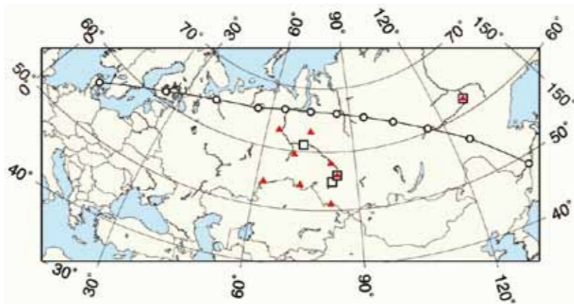
シベリア上空で行われている温室効果気体観測。季節変動は地上付近の振幅が大きく、上空ほど小さいことがわかってきました。 ○-○：日本航空定期便による大気採取観測。2012年4月から2013年1月まではパリー羽田間、その後はモスクワ-成田間で観測を行っています。 ▲：地上におけるタワー観測 □：チャーター航空機観測
