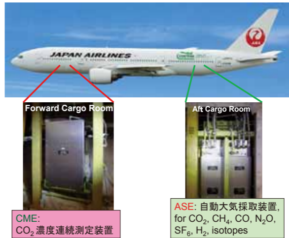
日本航空777-200型に搭載されている2つの観測装置。ジェットエンジンから取り込まれた空気が機内空気と混合する前に採取装置に入るようになっています。ASEは日本に到着した翌日には環境研に送付され分析が行われます。（写真提供：日本航空）
