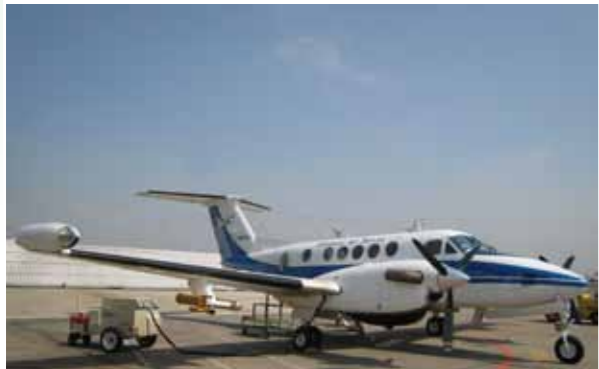
日本では大気観測を行えるチャーター航空機は数が限られています。キャビンの客席を取り外し、各種測定器を搭載した特別機で観測を実施します。機体上部にはエアロゾルや気体の取り込み用インレットがつけられるとともに、両翼下にはエアロゾル・雲測定器や風速を測定する装置などが搭載されています。（撮影：小池）
