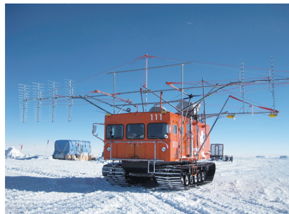
図6：2018/19シーズンに内陸氷床探査で使用したアイスレーダー
