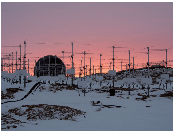
図5：昭和基地に設置されたPANSYレーダーのアンテナ群。左奥の円形の建物は大型のパラボラ・アンテナが収められたレドーム。
