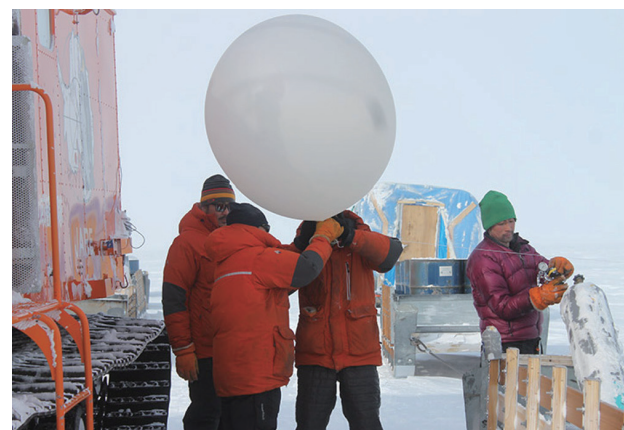
図 25：内陸でのゾンデによる気象観測
