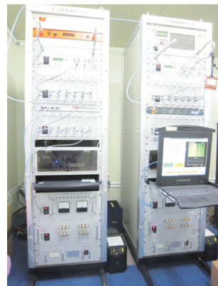
図：昭和基地のFMCW型電離層観測機
