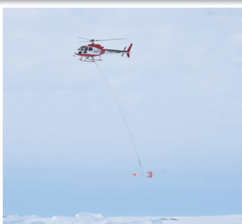
ヘリ吊下型の電磁誘導型氷厚センサ
