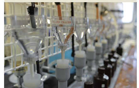
ろ過によってフィルター上に微生物を捕集
