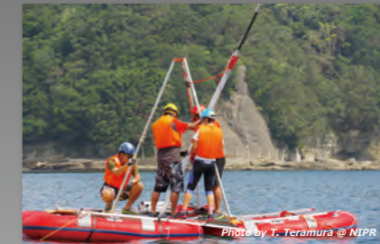
コアリングボートによる堆積物採取（訓練） ボート上から堆積物を採取します。
