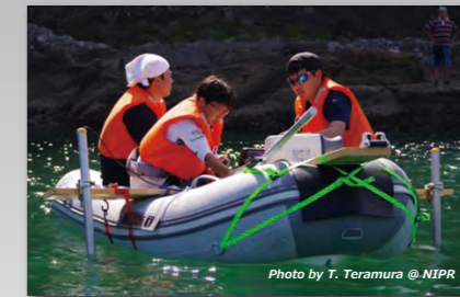
ゾディアック型ボートによる測深（訓練） 魚群探知機を応用して測深します。
