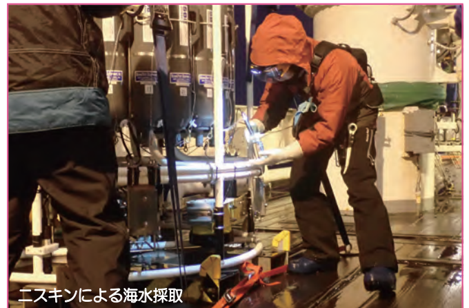
CTD-RMSシステムによる深層水観測（水温・塩分）
