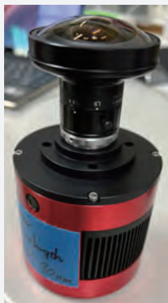
左) 極冠カメラ（新型）のプロトタイプ。光学フィルタを内部に導入し、小型化した 右) 極冠カメラ（新型）のプロトタイプを複数台組み合わせ、校正実験している風景
