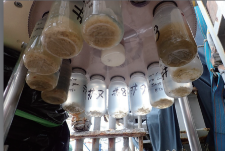
物理・生物共同研究グループでの係留系観測の係留系(右)と回収した1年分のサンプル(上) 温度・塩分だけでなく、1年間分の沈降粒子(マリンスノー)を観測し、生物の季節変動を解析する事ができます。
