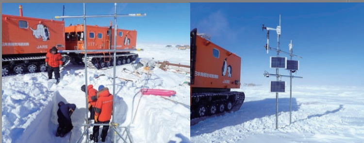
大陸氷床上(MD78)にAWSを設置している様子(左)と設置したAWS(右) 高精度気温観測のほか、放射収支、積雪深、雪温の観測も行っています。
