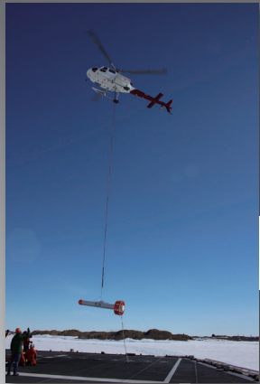
「しらせ」を発艦するヘリと EM-bird (吊下型の電磁誘導型氷厚センサー)
