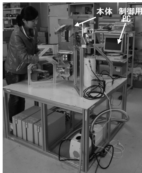
図 3. 実験室で最終調整中の小型ミリ波超伝導分光放射計。
