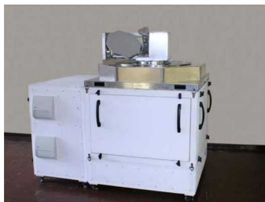
図 3. 30-cm 可搬型サブミリ波望遠鏡
