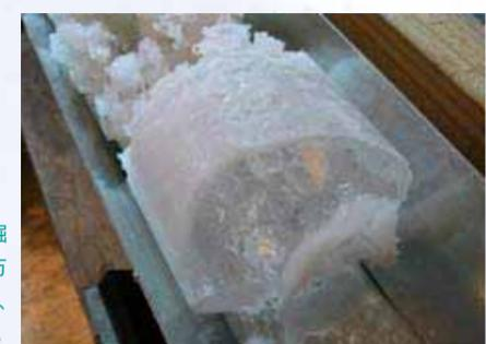
岩盤間際の深さ3035メートルから掘りだされた氷床コア。年代は約72万年前。岩盤の上の氷は地熱で融けて、掘削孔に水がしみこんでいました。
