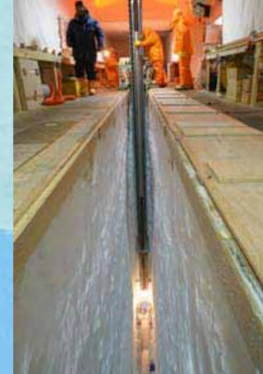
氷床コアの掘削。ドリルを掘削孔に降ろして約4メートルのコアを掘りだし、それを引きあげたら、ふたたびドリルを降ろして掘削するという作業がくりかえされます。
