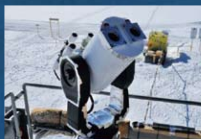
「シーイング観測用の望遠鏡」 観測ステージに載せて、開口部が雪面から高さ11mになるように設置している。
