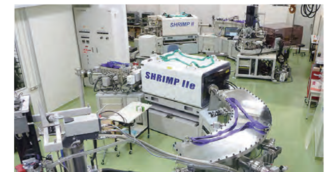
鉱物の年代測定を行う二次イオン質量分析計 (SHRIMP)
